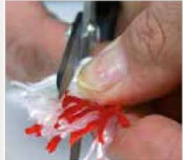
und fixieren Sie je ein Klebeband um das verjüngte Kernende sowie das verjüngte Mantelende
