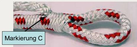
Ziehen Sie den Kern ein kleines Stück aus dem Auge und schneiden Sie diesen sehr knapp bei der Austrittsstelle ab. Achten Sie darauf, beim Abschneiden den Mantel nicht zu verletzen.
