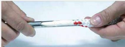
12. Stechen Sie die Spleißnadel bei Markierung 2 in den Kern und führen Sie die Nadel in Richtung Markierung 3.
