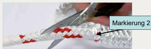
18. Hängen Sie den Knoten aus Schritt 1 an einen gut verankerten Haken und streifen, melken Sie den Mantel schrittweise in Richtung Spleißauge.
