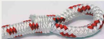
Ziehen Sie an dem Spleißauge, damit der Kern vollständig im Spleiß verschwindet. Wenn notwendig, können Sie ein Takling setzen
